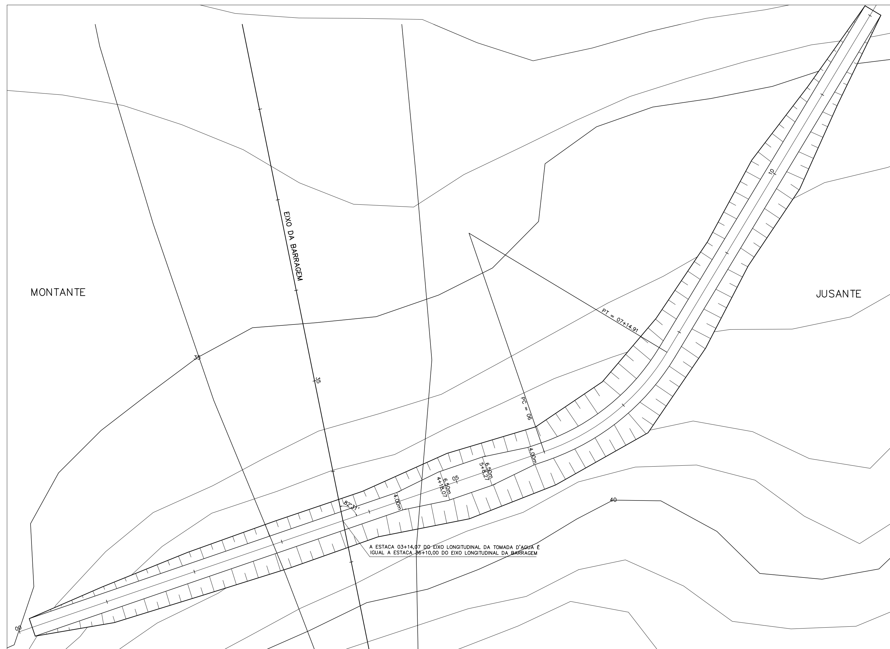
PLANTA DE ESCAVAÇÃO DA TOMADA D'AGUA ESCALA - 1:500
